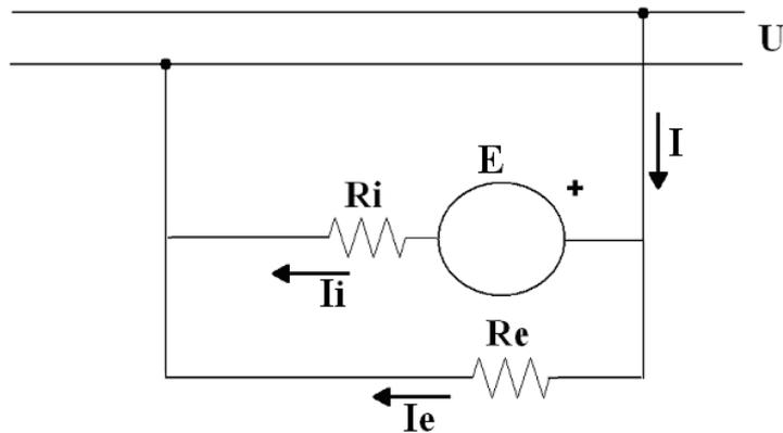
Circuito eléctrico equivalente del motor DC de excitación derivación.
