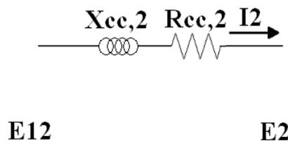
Circuito eléctrico equivalente por fase del transformador referido al secundario.
