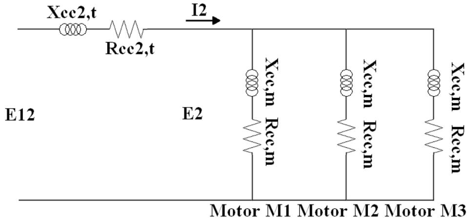
Circuito eléctrico equivalente referido al secundario del transformador.
