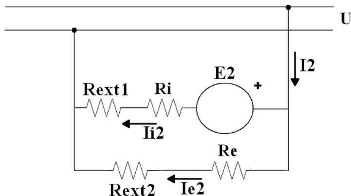
Circuito eléctrico equivalente del motor DC de excitación derivación con las resistencias externas.
