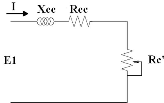
Circuito equivalente del motor de inducción, despreciando la rama en paralelo.
