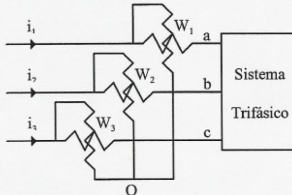
Vamos a demostrar que la potencia de un sistema trifásico desequilibrado es igual a la suma de las indicaciones de los tres vatímetros.
