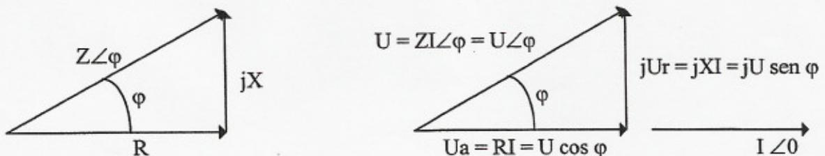
Multiplicando nuevamente este triángulo de tensiones por I, obtenemos el triángulo de potencias
