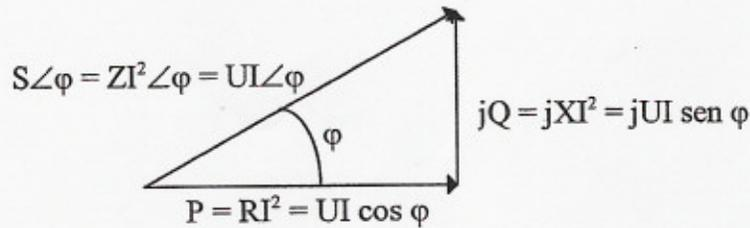
El cateto horizontal  $P = RI^2 = UI \cos \varphi$ , representa la potencia absorbida por la componente resistiva, es decir la *potencia activa*.
