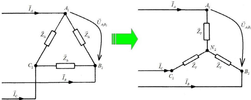
El circuito, después de la transformación, queda como se ve en la siguiente figura.
