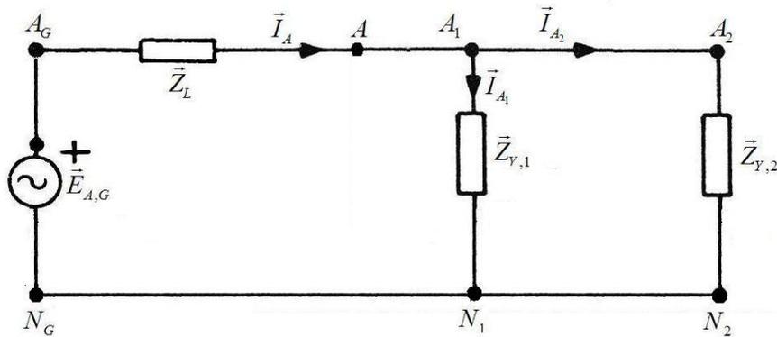
Las impedancias por fase de las cargas 1 y 2 se encuentran conectadas en paralelo. Se pueden sustituir por una única impedancia.
